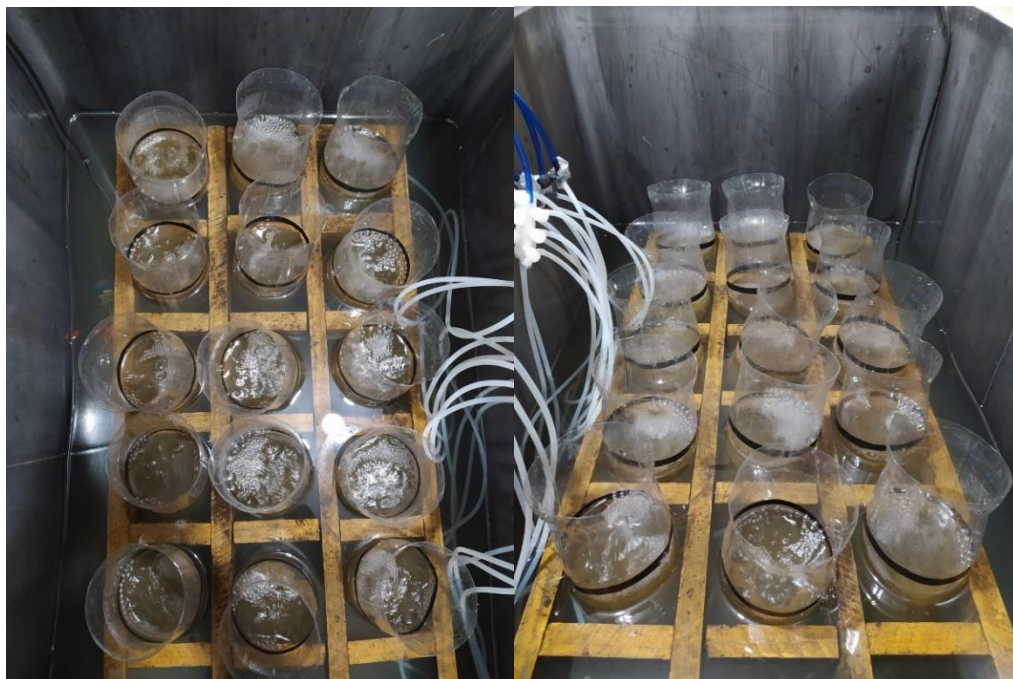
Figura 2. Estrutura confeccionada para a realização do teste dose-resposta, contendo garrafas PET's com sistema de aeração independente e controle de temperatura através de um “banho-maria”.
