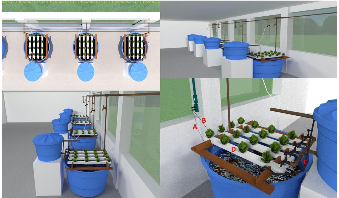
Figura 1 – (arquivo pessoal) diferentes vistas das unidades experimentais dentro da estufa de cultivo. A: fonte de energia do aquecedor; B: fonte de energia bomba de sucção, C: mangueira de condução da água para o sistema de distribuição nas calhas NFT e D: sistemas decalhas NFT (Nutrient Film Technique).
