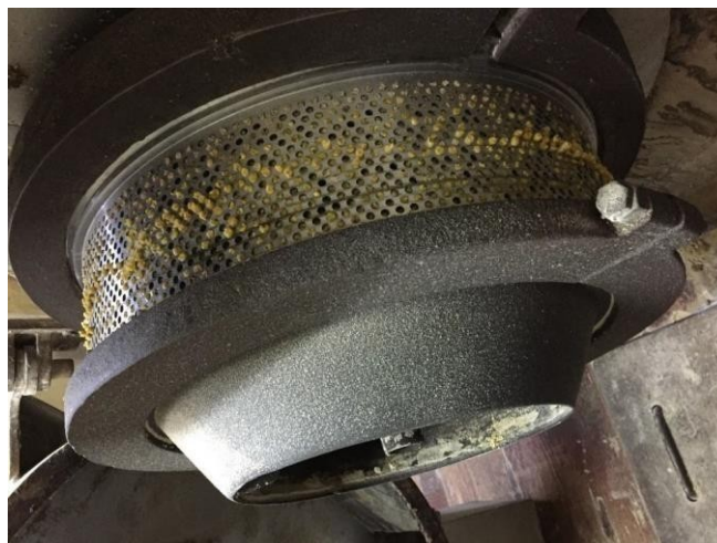
Figura 2: Equipamento nomeado como prensa matriz, responsável por dar forma aos pellets .
